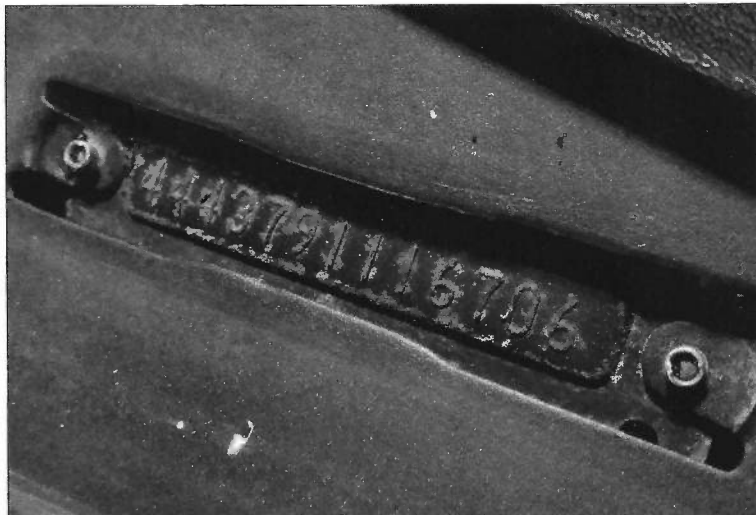
Plåten i vindrutan, som jänkarna förlitar sig på, duger inte i Sverige. Den är för lätt att byta ut och fiffla med. Stansat på ramen ska det vara på dessa rambyggda bilar. Det betyder att man i praktiken tvingas till en förenklad registreringsbesiktning om man köper en annan ram som reservdel.
